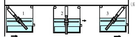
走--图 2。限位开关触碰动作后,焊枪自中点摆动到终点位置结束焊接收弧延时 2S (削除弧坑)--图 3。此间可根据焊接效果对小车行走参数、焊枪高度及焊接参数进行 微调。
